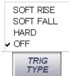
トリガ種類がリストされますので希望の種類をクリックします。
