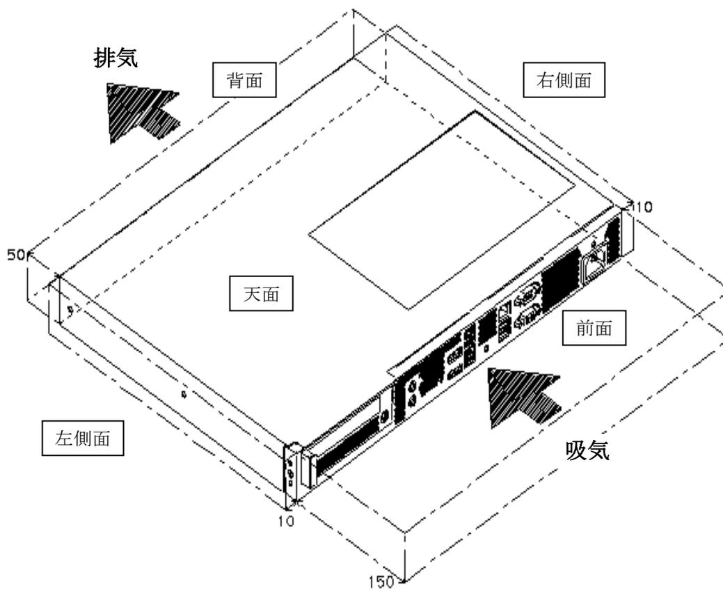
※吸気、廃棄のエアフローを確保できるように設置してください。
