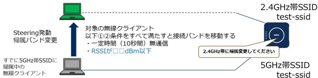
Case2 帰属している2.4GHz帯のSSIDが、一定時間 (10秒間) 無通信の場合
