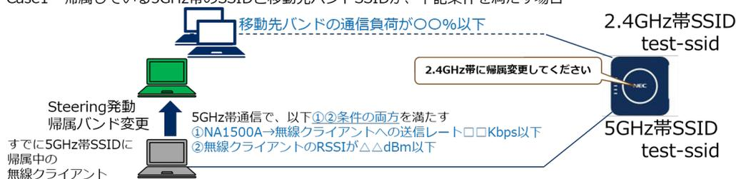
Case2 帰属している2.4GHz帯のSSIDと移動先バンドSSIDが、下記条件を満たす場合
