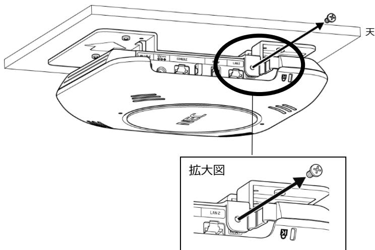
3. 本体のツメのロックを外して、手で支えながら、本体を矢印の方向（ランプ側の方向）へゆっくりスライドさせる
