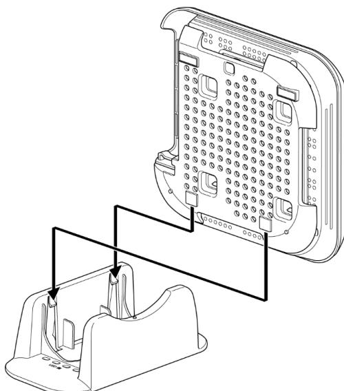
※下の図のように、本体表面にある穴と縦置きスタンドの○印の位置を合わせるように差し込んでください。
