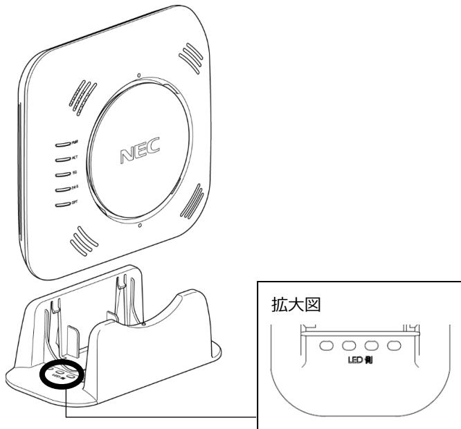
2. 図のように、本体裏面のアンダーカバーにある四角い凸部を縦置きスタンドのツメに合わせて、本体を上から差し込む
