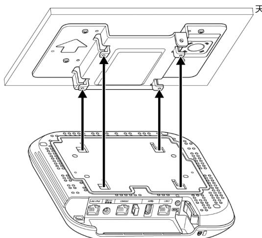
※下の図のように、本体表面にある穴をアタッチメントの○印の位置に合わせると、差し込みやすくなります。
