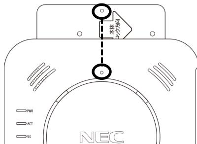
5. 本体を矢印の方向（ケーブル側の方向）にスライドさせる
