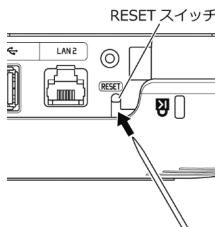
3. POWER、ACTIVE、5GHz、2.4GHz、OPTION ランプが**紫点灯**したら、RESET スイッチを放す
