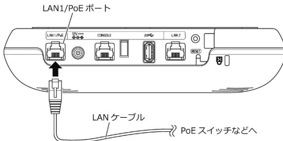
**重要**：本商品の電源を PoE から給電する場合は、必ず IEEE802.3at/af 規格対応の PoE スイッチを使用してください。
