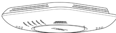
壁に取り付ける場合は、図のように、ランプ側を左にして取り付けてください。
