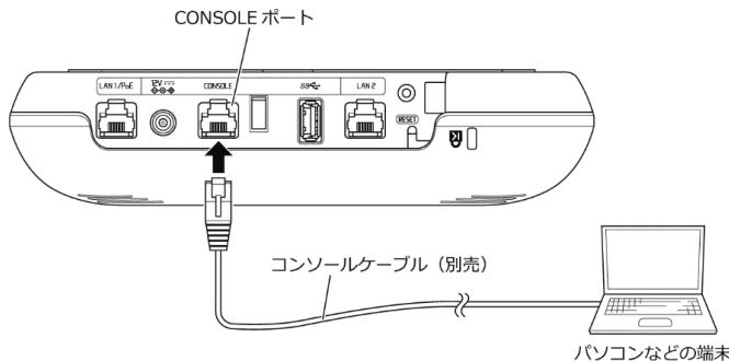
※パソコンなどの端末側でUSB端子を使用する場合は、市販のUSB-RS232C変換ケーブルを使用してください。
