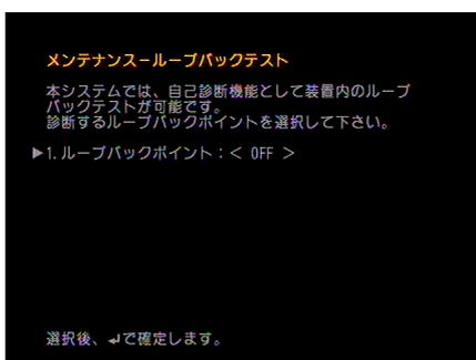
① 「ループバックテスト」を選び、「OFF」、「VIDEO」、「AUDIO」、「IP」を設定します。
