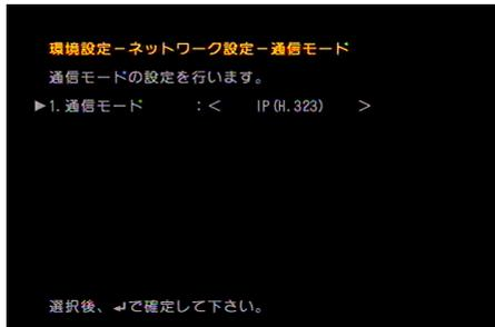
① 「通信モード」を選び、「IP (H.323)」、「IP (SIP)」を設定します。
